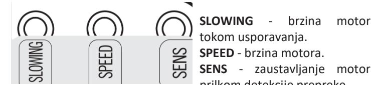
**SLOWING** - brzina motora tokom usporavanja.
