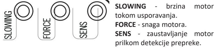
**SLOWING** - brzina motora tokom usporavanja.
